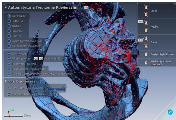
Rys.7. Wczytywanie chmury punktów do programu Geomagic Desing X
